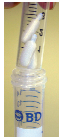
Corpo da seringa com esponjas inseridas no tubo cônico para centrifuga.
